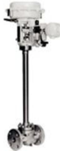
Desarrollado para aplicaciones de servicio criogénico, tiene un capó extendido diseñado para mantener una pequeña porción de fluido vaporizado entre la caja de relleno y el líquido a temperatura criogénica. Una válvula reconocida por su rigurosa precisión y máxima estabilidad.
